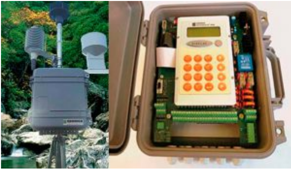
Figura 0. Estación meteorológica (Geonica Meteodata 2008CP) y sensores.
